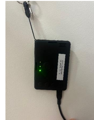
Dispositivo «uomo a terra» (man down)
