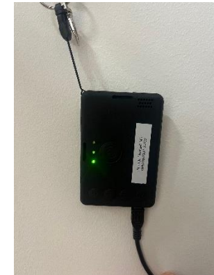
Dispositivo «uomo a terra» (man down)
